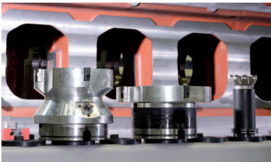
Die ProfiMill für JDEC wurde mit vollautomatischen Werkzeug- und Aggregatewechslern ausgestattet.
