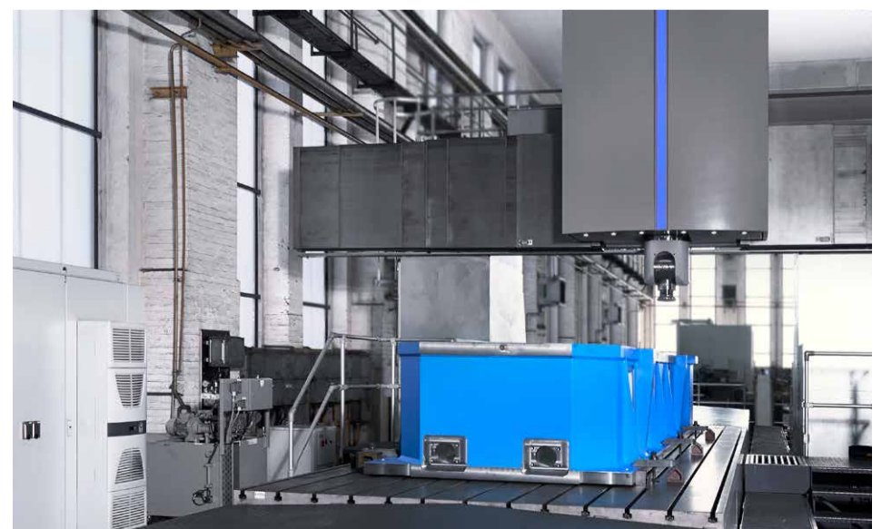
Die ProfiMill compact bearbeitet das Gehäuse eines XXL-Helikopterprüfstandgetriebes
