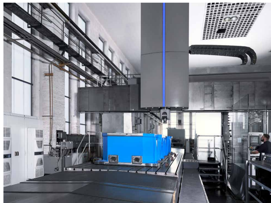
Die ProfiMill 1 bearbeitet das Gehäuse eines XXL-Helikopterprüfstandgetriebes
