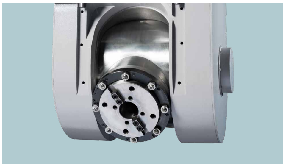
Universalspindelkopf zur flexiblen Bearbeitung der Laminatpressen-Komponenten
