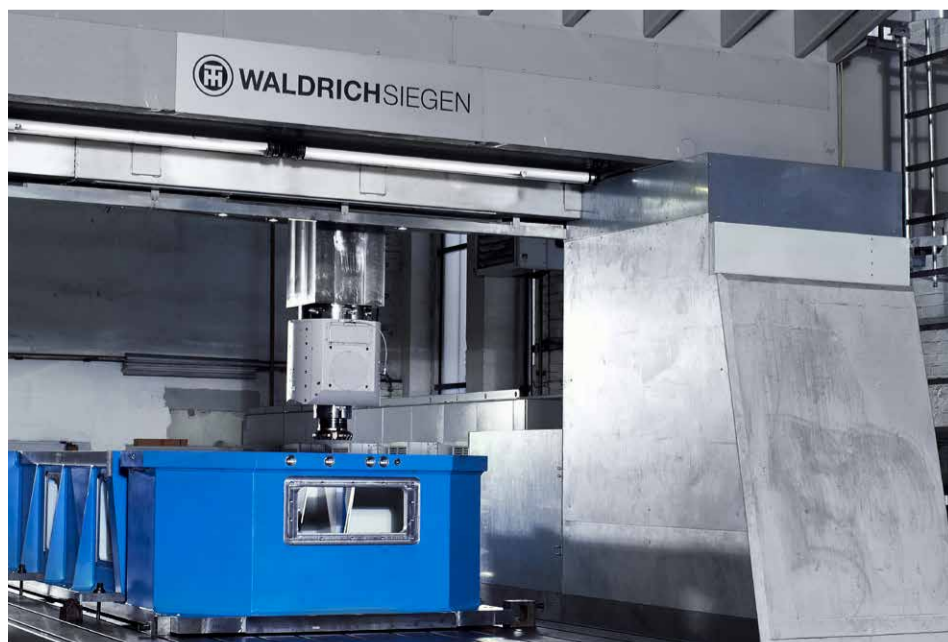
Der optionale Betonständer erhöht die Maschinensteifigkeit um ein Weiteres
