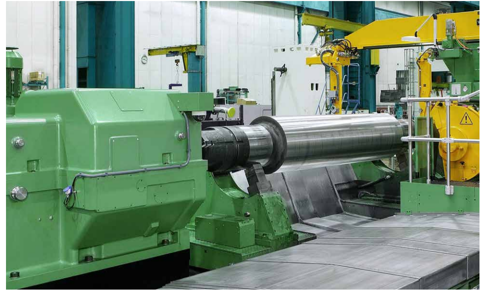
Nach der Komplettmodernisierung arbeitet die Walzenschleifmaschine wie neu
