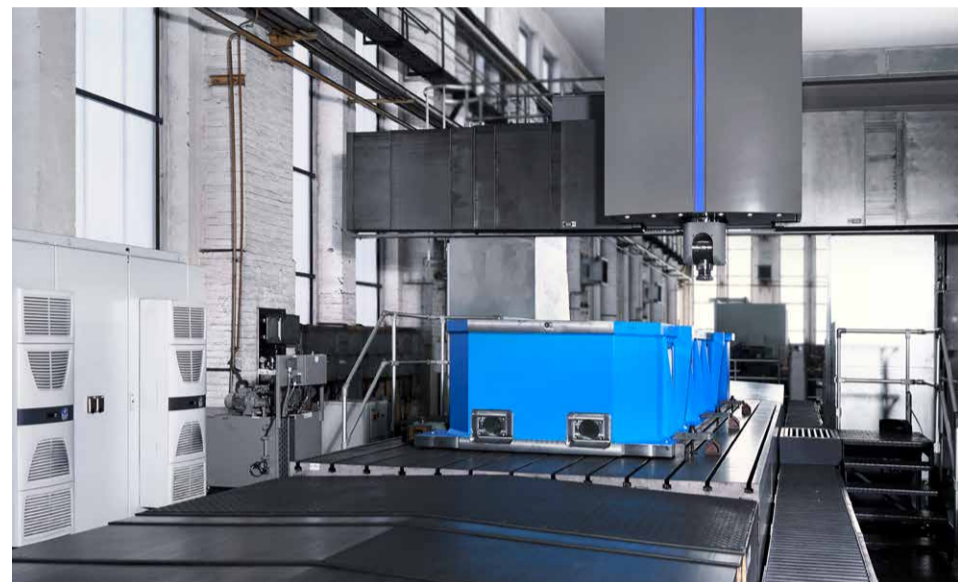
ProfiMill Baugröße 1: kompakte Bearbeitungsmaschine für kleine bis mittelgroße Werkstücke
