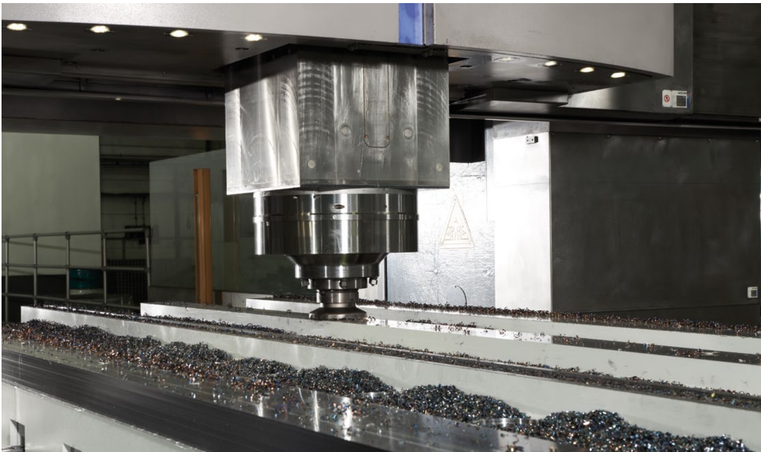
Bearbeiten einer Führungsbahn bei Herkules Meuselwitz
