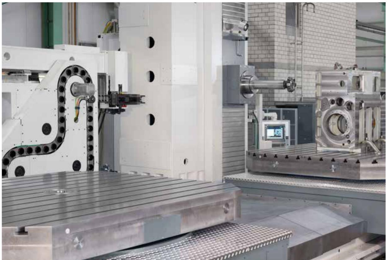
höchste Genauigkeiten während des Bearbeitungsprozesses problemlos erreicht. Die Maschine verfügt über Verfahrenwege von 2.500 x 2.000 x 2.100 mm (X, Y, Z). Werkzeuge unterschiedlichster Art können über ein flexibles Wechselsystem mit 80 Plätzen ausgetauscht werden.
