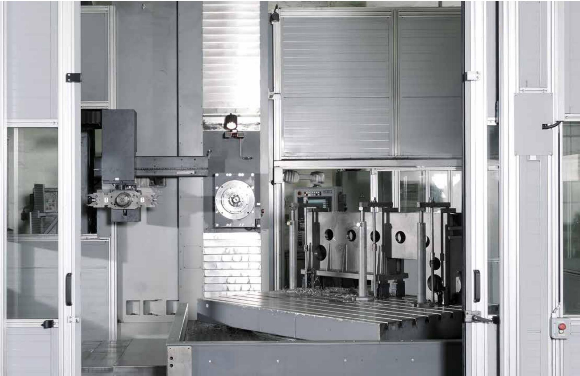
Horizontal-Bohr- und Fräsmaschinen der T-Serie in Tischausführung sind optimal auf die effektive Mehrseitenbearbeitung von mittelschweren Werkstücken ausgelegt
