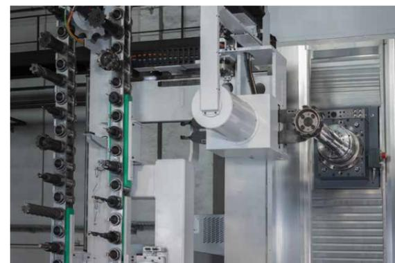
Automatisierter Werkzeugwechsel für hohe Bearbeitungsgeschwindigkeit
