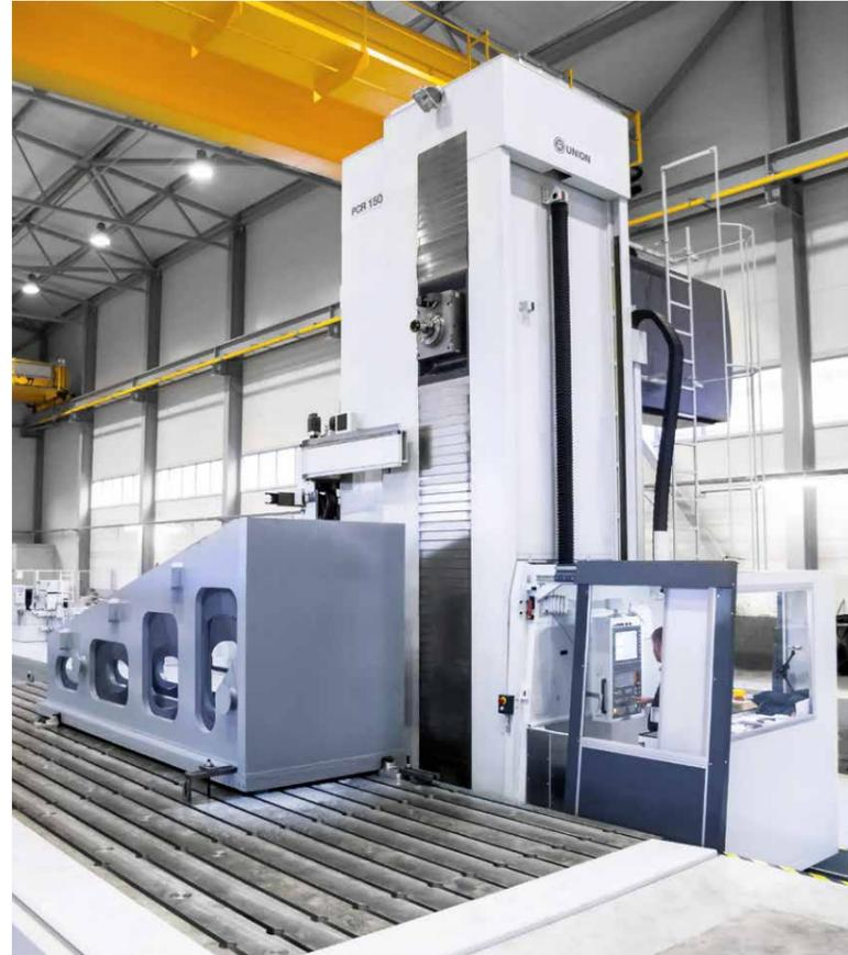
Die Horizontal-Bohr- und Fräsmaschinen der PR-Serie sind die idealen Werkzeugmaschinen für die Bearbeitung großer Bauteile
